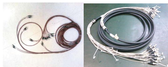
图 3 触发光缆组件实物
