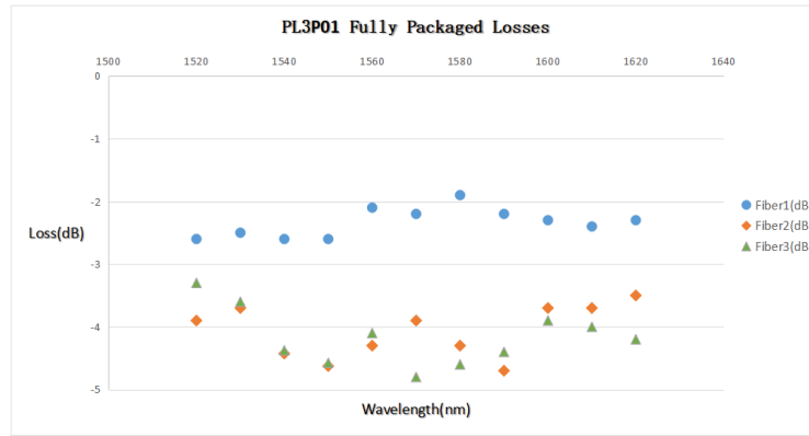
图 5 三模选模光子灯笼 1530nm~1600nm 损耗
