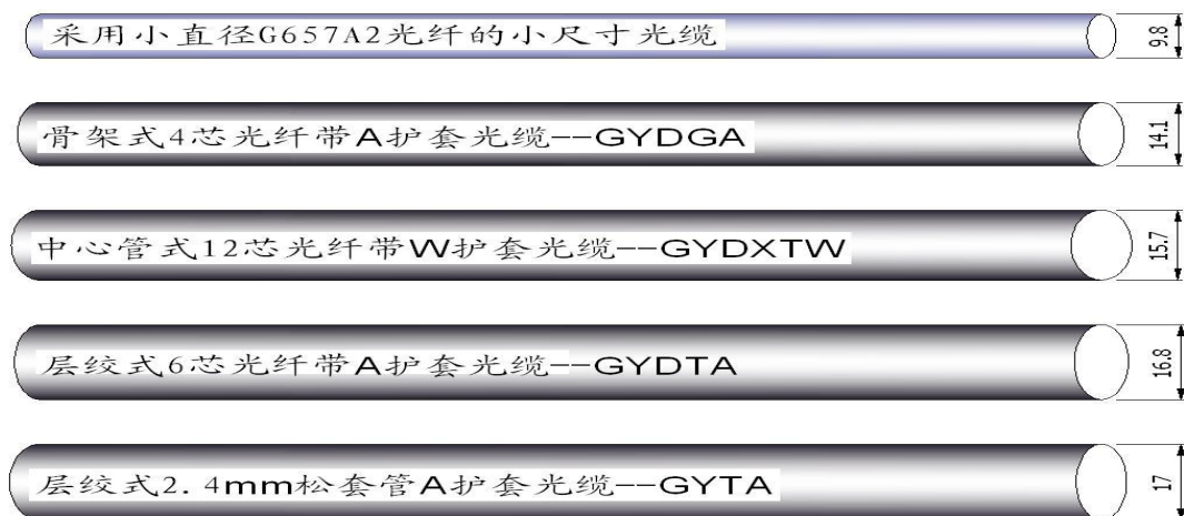
图 2. 不同结构管道敷设光缆的直径对比
