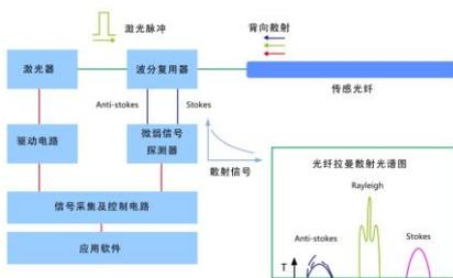
图 1 拉曼测温原理图
