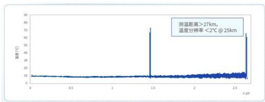
图 4 长飞测温多模光纤温度曲线图
